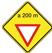
Proximidad de Señal Restrictiva (Paso) P 33
