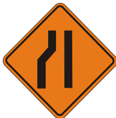
Estrechamiento de Calzada T 4
